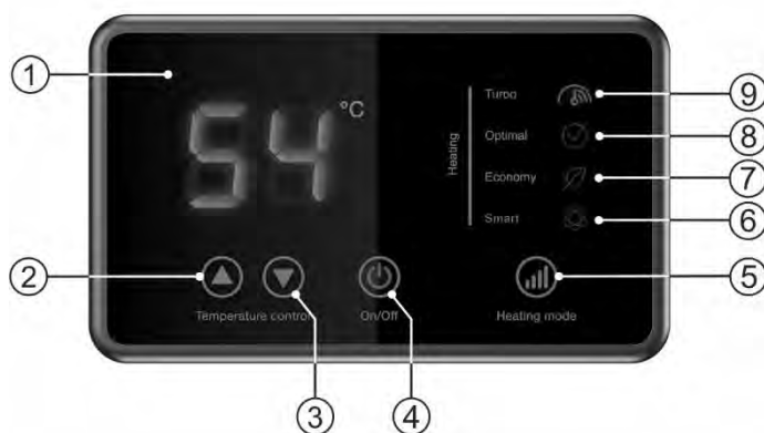
Figura 2. Pannello di comando elettronico
